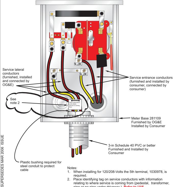
**CONNECTION DIAGRAM** SINGLE PHASE 320-AMPERES MAXIMUM
