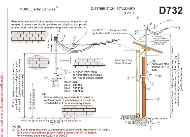
see NESC Table 232-1 footnotes 7 and 8. **FURNISHED BY INSTALLED BY ITEM DESCRIPTION** NO. **CONSUMER** O.G.& E. **CONSUMER** O.G.& E. Χ 1 SERVICE DROP Χ Χ 2 SERVICE DROP BRACKET Χ SERVICE ENTRANCE Χ 3 Χ CONDUCTOR Χ SERVICE HEAD 4 X SERVICE RACEWAY Χ 5 Χ SERVICE EQUIPMENT Χ 6 Χ 7 Χ METER BASE Χ 8 SELF-CONTAINED METER Х Χ **GROUNDING ELECTRODE** 9 Х Χ CONDUCTOR 10 **GROUNDING ELECTRODE** Χ Χ
